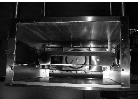
9. Le corps de four est maintenant prêt à être essuyé. Rassemblez les pièces de doigt et de convoyeur dans l'ordre d'inversion après nettoyage.
