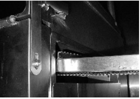
3. Soulevez vers le haut l'extrémité gauche de l'armature de convoyeur ainsi des appuis de plateau de miette clairement l'ouverture de four. Poussez l'armature de convoyeur par l'ouverture de four.
